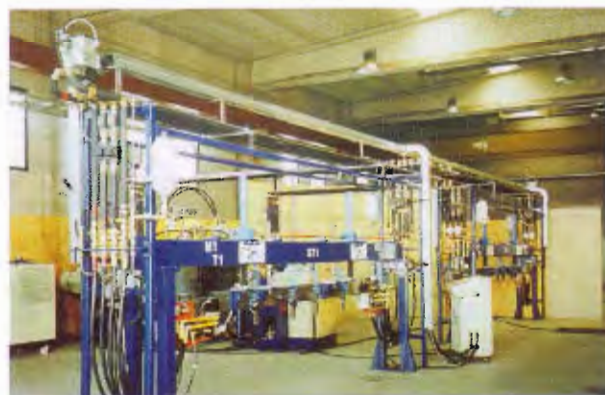
Завод по производству панелей прерывным способом (для холодильных камер, холодильников) с машиной мощностью 10кВт
