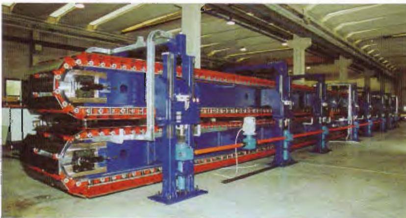
Конвейер для бумажных панелей, работающий со скоростью 60 м/мин
