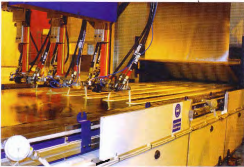
Система высокоскоростного ламинирования с тремя смешивающими головками
